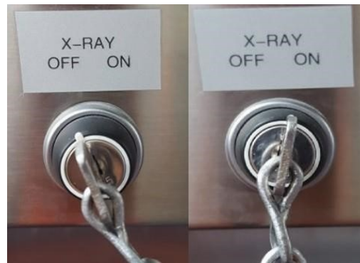
Figura 18 Llave de Rayos X de posición ON a OFF.
